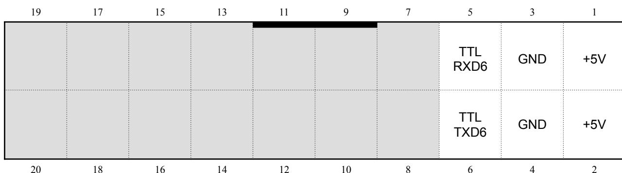
Данный разъем предназначен для подключения устройств (часто купюорприемников), которые имеют TTL интерфейс подключения с прямой логикой: 0 — 0V, 1 — +5V. На некоторых купюорприемниках (CashCode, MEI) он обозначается «*opto-isolated*». ВНИМАНИЕ! ЗАПРЕЩАЕТСЯ ПОДКЛЮЧЕНИЕ К ЭТОМУ РАЗЪЕМУ УСТРОЙСТВ С ИНТЕРФЕЙСОМ RS-232 (0 — +12V, 1 — -12V), ТАК КАК ЭТО ПРИВЕДЕТ К ВЫХОДУ ВСЕЙ ПЛАТЫ ИЗ СТРОЯ И ПОСЛЕДУЮЩЕМУ ДОРОГОСТОЯЩЕМУ РЕМОНТУ.
